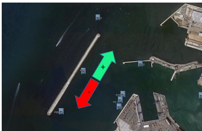
Fig. 4 – Posizione del correntometro RCM7 presso la diga foranea nel porto di Ancona. Le frecce indicano le possibili direzioni delle correnti registrate dal correntometro unidirezionale.
