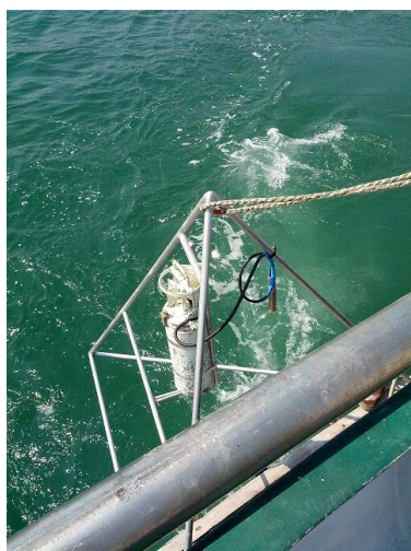
Fig. 3 - Correntometro RCM7 collocato all'interno della struttura metallica durante l'immersione presso la diga foranea di Ancona.
