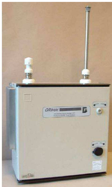
Figura 1 - Analizzatore spettrometrico per polveri Environcheck
